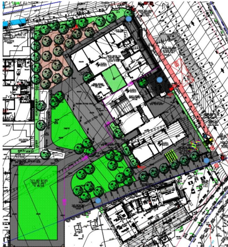
תרשים 7- תוכנית הפיתוח של המגרש עם סימוני מיקומי בורות החלחול
